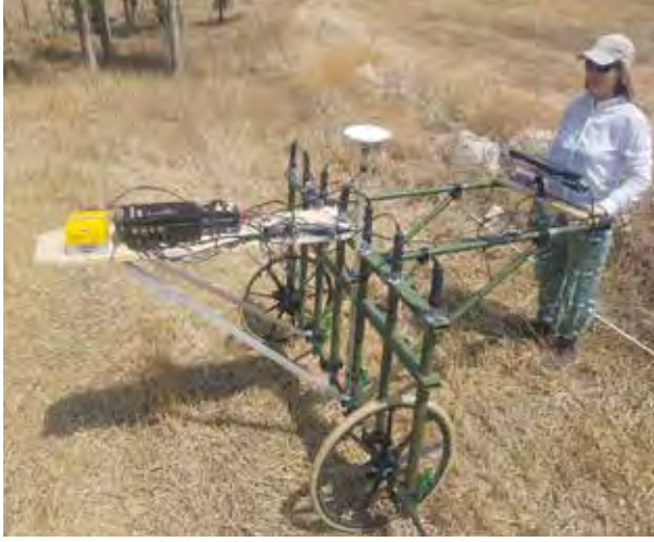
Resim 1: GPS Entegre edilen 25 cm Aralıklı 7 sensörlü Fluxgate Manyetometresi (FGM).
