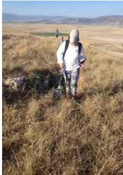
Resim 4: 2019 yılı Hisar Tepe’de GPR (Geoscanners) taşıma sistemi ile ölçü alımı.
